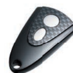
Fjärrkontroll Micro-Novotron 512 Design 2-kanals, 433 MHz, KeeLoq-växelkod
