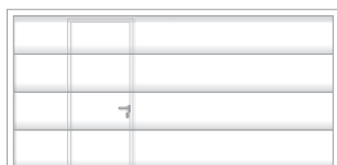
Symmetrisk placering vid BRMB 2,000 - 3,500 mm endast i mitten
